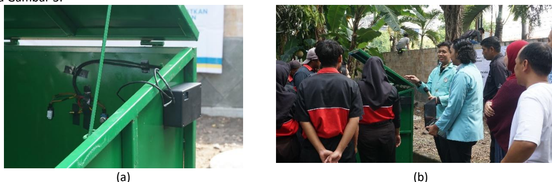
Gambar 3. Implementasi sistem komposter berbasis IoT (a) pemasangan sensor suhu pada komposter, (b) penggunaan komposter oleh mitra.
