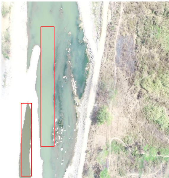
Gambar 6. Penampakan dasar sungai yang lebih dalam (kotak merah) daripada sekitarnya (Sumber: Foto Udara 1 September 2023)
