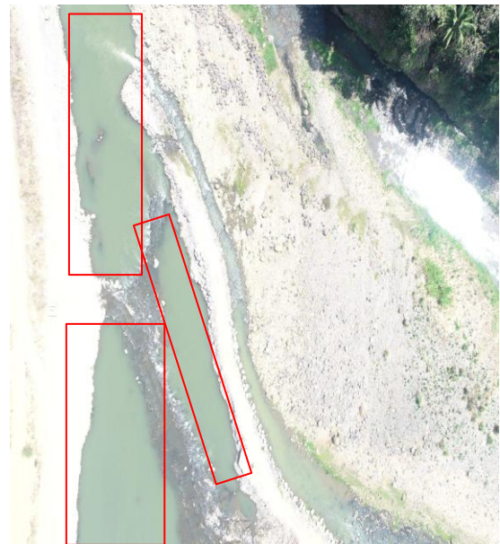
Gambar 7. Penampakan dasar sungai yang lebih dalam (kotak merah) daripada sekitarnya akibat penggalian dasar sungai untuk mengambil dan menangkap pasir (Sumber: Foto Udara 1 September 2023)
