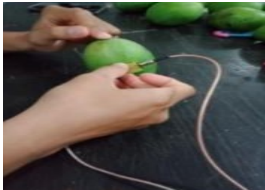
Gambar 3. Proses pengukuran nilai S_{21} dan impedansi buah mangga menggunakan sensor Double Ring Resonator [7]
