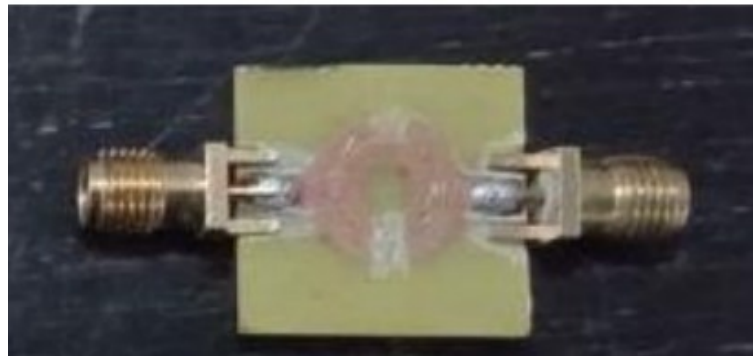
Gambar 1. Sensor double ring resonator yang digunakan dalam pengukuran nilai dielektrik buah mangga [7]
