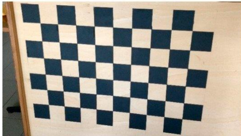
Gambar 3. Contoh panel kayu dengan motif kotak-kotak berukuran masing-masing 10 x 10 cm (Dabove dkk, 2019).
